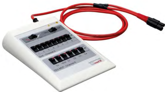
マトリックスボックス 540559 刺激電極の組合せをボタンで変更可能
